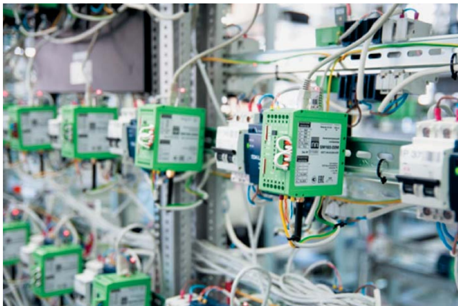
Рис. 1. Интеллектуальный контроллер SM160-02M
